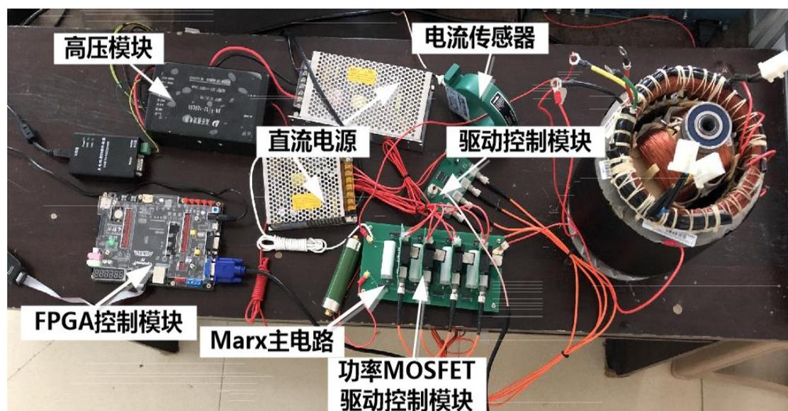
图 2-4 全固态高压脉冲电源样机
