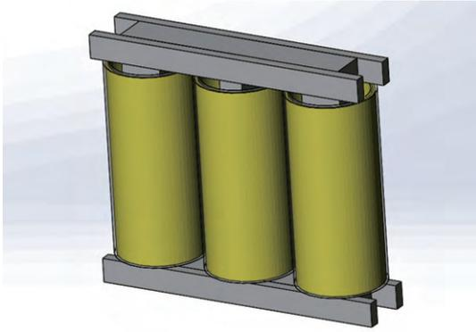
图3 铁芯电抗器三维温度场仿真模型
